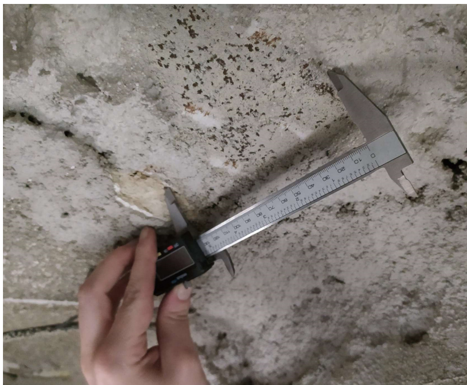
Sonda V3 – Odměření šířky spodní pásnice ocel. nosníku
